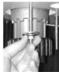
6. Нанесите защитную смазку на вал и промежуточную втулку. Установите сборку редуктор/эл.мотор снизу на промежуточную втулку. Отведите эл.мотор в сторону от места прохождения троса/цепи и затем вручную затяните пластиковую контргайку.
