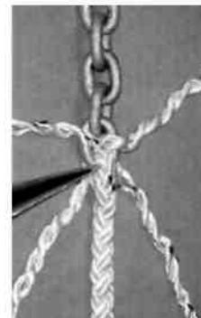
3. Закончив плетение, обрежьте и оплавьте концы с помощью горячего ножа.
