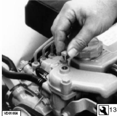
Уровень охлаждающей жидкости должен быть примерно на 1 см ниже нижней кромки заливной горловины.
