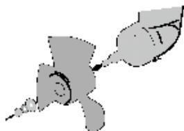
Установите один (1) сальник между хвостовой частью и тоннелем ПУ. Нанесите герметизирующий состав (полиуретан или силикон) между хвостовой частью и сальником и вставьте хвостовую часть в отверстие в тоннеле ПУ. ◀
