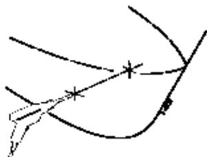
Пропустите разметочный инструмент (самостоятельного приготовления) через оба просверленных отверстия и отметьте на корпусе наружный диаметр тоннеля ПУ. ◀
