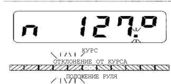
4 Чтобы привлечь внимание к ситуации, когда отклонение от курса достигает 25 градусов, освещена только последняя ячейка светодиодной панели. При отклонении более 25 градусов последняя ячейка мигает.
